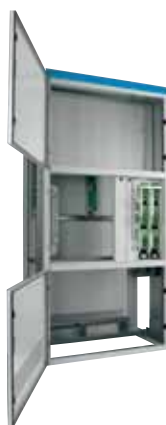
Pola odpływowe dla rozłączników listwowych do 630 A z szynami rozdzielczymi do 1600–3200 A (SL-I), przechodzącymi przez dwie sekcje
