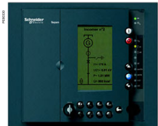
Commande locale à partir de l'IHM synoptique.
