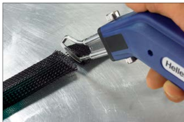
Cięcie przy pomocy HSG0 zapobiega rozplataniu się opłoty.
