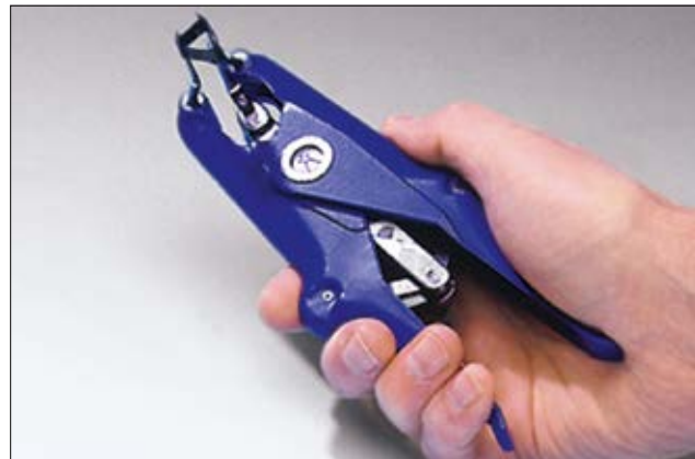
Szybki i wygodny montaż przy pomocy rozwieraków trójkątnych.
