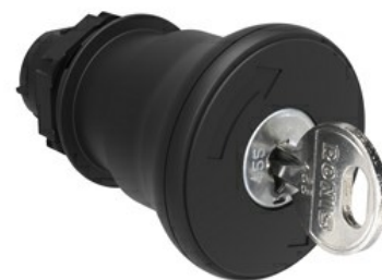
Przycisk do zatrzymania awaryjnego (grzybki), Blokowanie, odblokowanie przez przekręcenie kluczyka Ø 40 mm/1,6" LPCB684
