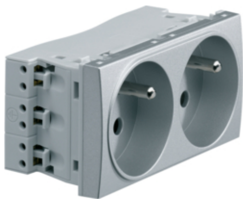
systo Gniazdo przełotowe z uziemieniem 2x(2P+Z) 16A/250V samozaciski 4M alu
