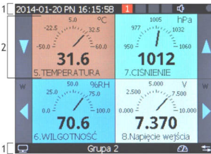
Rys.11.4. Wygląd ekranu grupy pomiarów w trybie WSKAŹNIK ANALOGOWY (możliwość prezentacji maksymalnie 6 kanałów)
