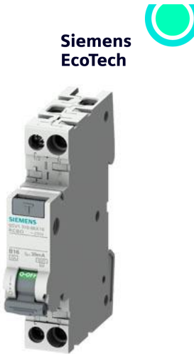
wyłącznik różnicowy / wyłącznik nadmiarowo-prądowy, kompaktowy 1 SM, 1 P+N 6 kA typ F 30 mA C16 superodporny K
