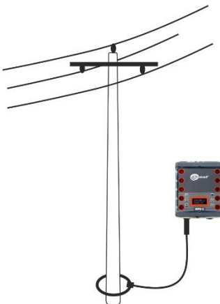
Rys.9. Praca przyrządu przy użyciu pojedynczych cęgów
