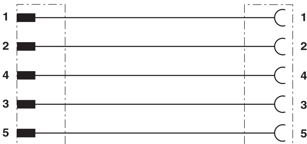
Przyporządkowanie styków wtyków M12 i gniazd M12
