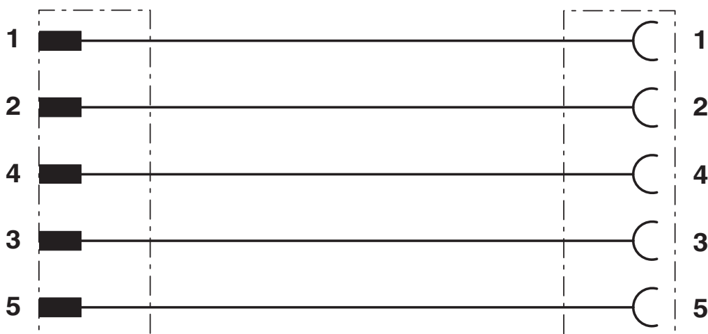
Przyporządkowanie styków wtyków M12 i gniazd M12
